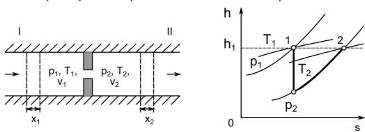
Рассмотрим процесс течения газа (жидкости) через трубу, имеющую местное сопротивление, например диафрагму. Сечение трубы до и после диафрагмы считаем одинаковым. Скорость потока до и после диафрагмы считаем пренебрежимо малой; это позволяет пренебречь значением кинетической энергии потока по сравнению с его энтальпией. Считаем, что стенки трубы окружены идеальной теплоизоляцией, исключающей теплообмен с окружающей средой. Рассмотрим так называемое адиабатное дросселирование.
